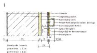
Drei-gängige Fassadenverkleidungs-Konstruktionen wurden unter dem Schwerpunkt Temperatur-, Partial- und Sättigungsdruckverlauf im Sommer und Winter untersucht.
